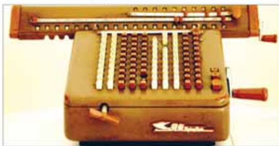
Sumatory (maszyna licząca do dziesięciu miejsc po przecinku).
